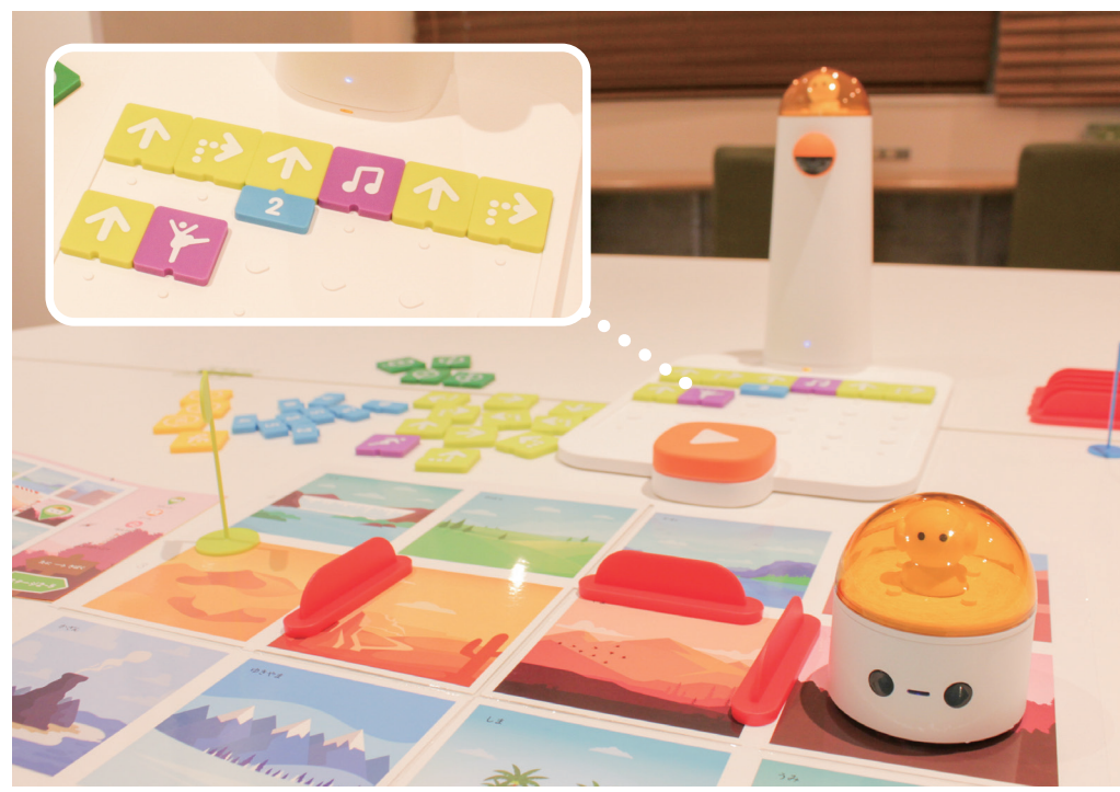
画像認識センサーでプログラムを読み取り、Bluetooth®でロボットにプログラムを送信
